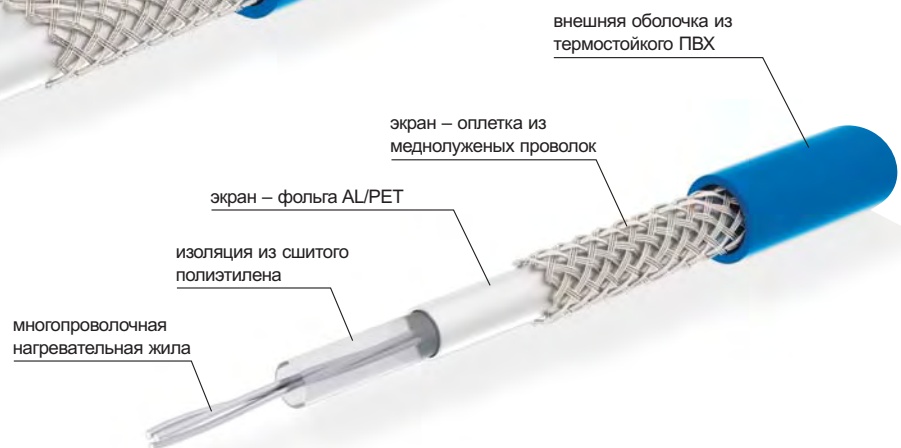
Конструкция нагревательного кабеля ELEKTRA VC
