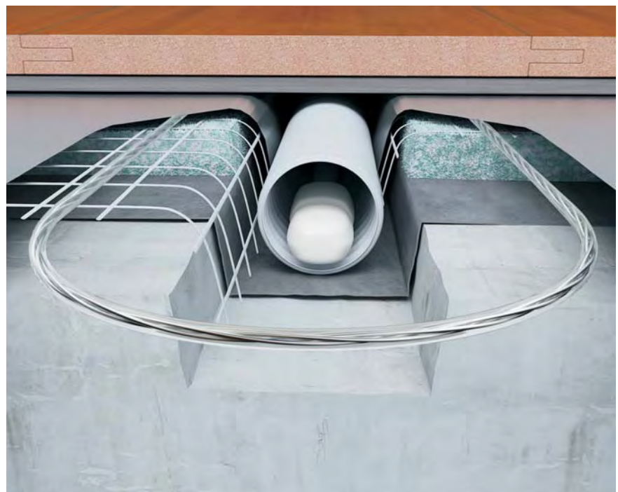
Установка датчика температуры (глубина штробы должна составлять 10-12мм)
