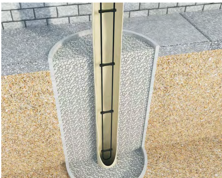
Монтаж нагревательного кабеля ниже уровня грунта
