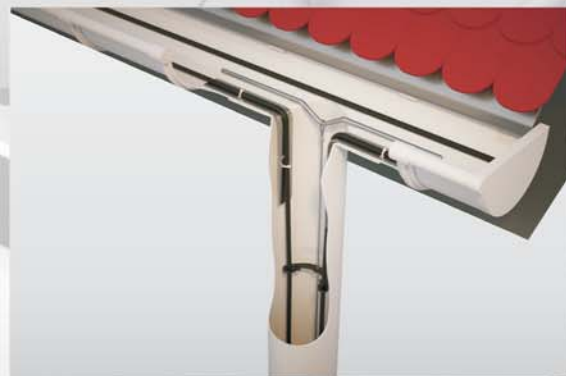
Защита нагревательного кабеля от острых углов.
